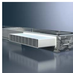
Schüco VentoTherm ist mit einem Außenluftfilter der Klasse F7 gemäß DIN EN 779 ausgestattet. Die Filterkassette kann schnell und ohne Werkzeug gewechselt werden.
