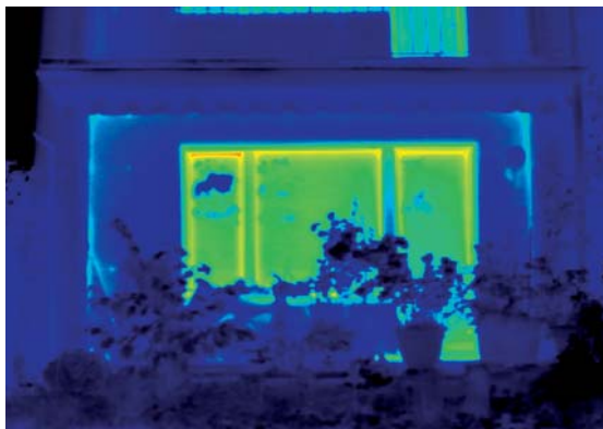
Infrarotaufnahmen - Thermografien - zur energetischen Bewertung von Gebäuden oben - vor dem Fenstertausch unten - nach dem Fenstertausch
